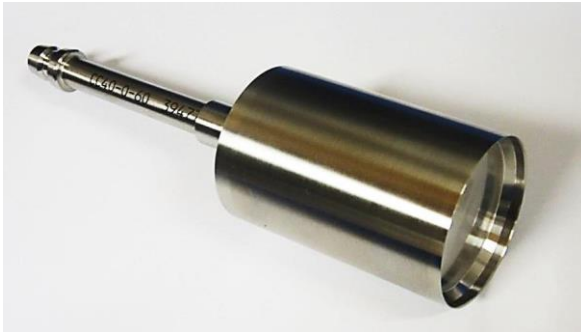
Рисунок 1. Спеціальна вимірювальна система (B-CC40), яка використовується в шоколадній промисловості.
