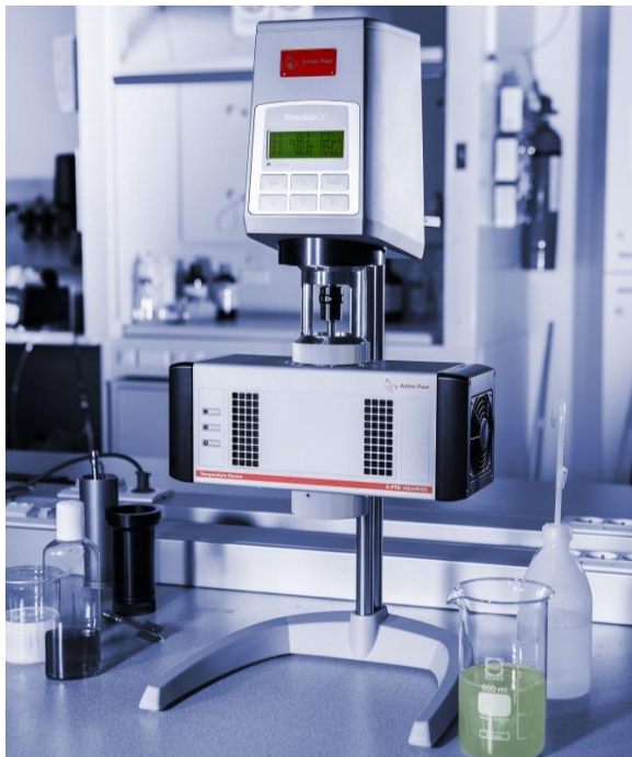
Рисунок 2. Ротаційний реометр RheolabQC з термостатуючою системою C-PTD 180/AIR/QC від Anton Paar.
